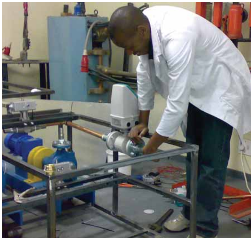
Konfiguration eines Durchflusssensors (Flowmeters) innerhalb einer Siemens-Prozessinstrumentierung © Bilder: Siemens
